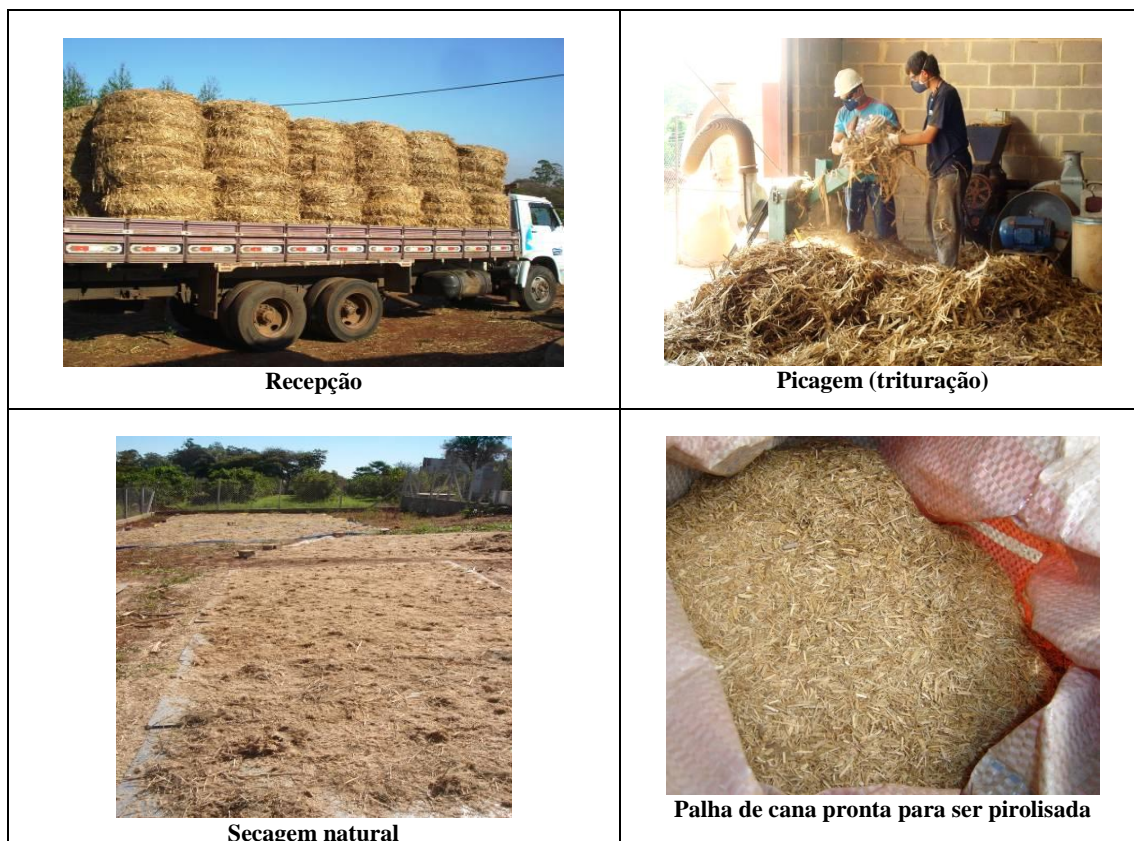
Figura 2. 4- Etapas de pré-tratamento da palha de cana em uma planta de pirólise rápida de biomassa em escala piloto (200 kg/h).
